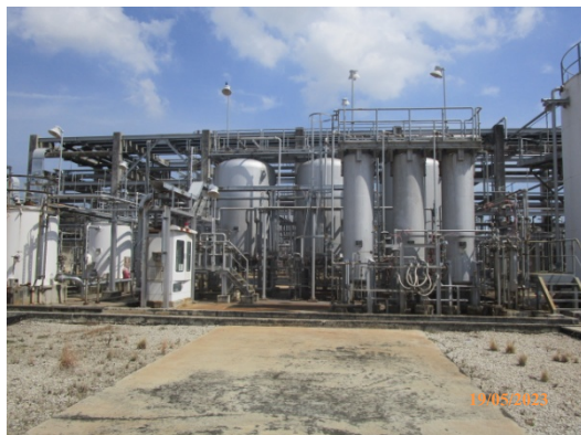
รูปที่ 21 Hg Treating Package สำหรับบำบัด น้ำปนเปื้อนปรอทจากถังเก็บฟลูออเรนจ์คอนเดนเสท
